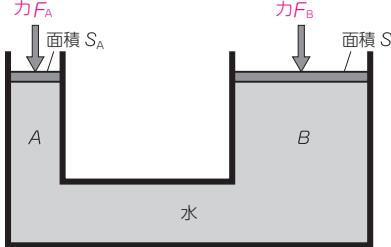
$\text{圧力 } P_A = \text{圧力 } P_B = \frac{\text{力 } F_A}{\text{面積 } S_A} = \frac{\text{力 } F_B}{\text{面積 } S_B}$ |
